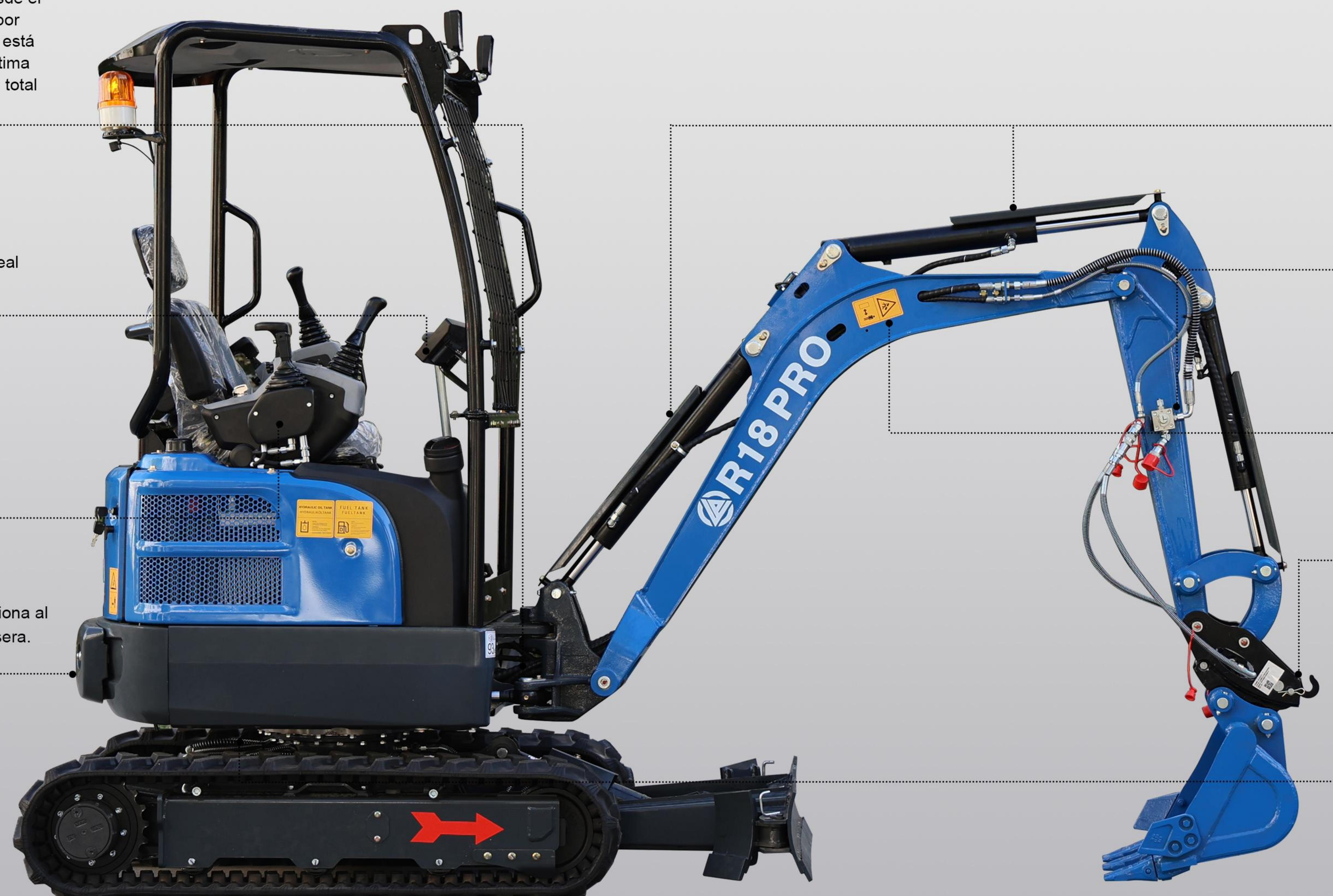
**Plus adicional en seguridad.** Se agrega un protector de cilindro al cilindro para protegerlo de manera efectiva.
