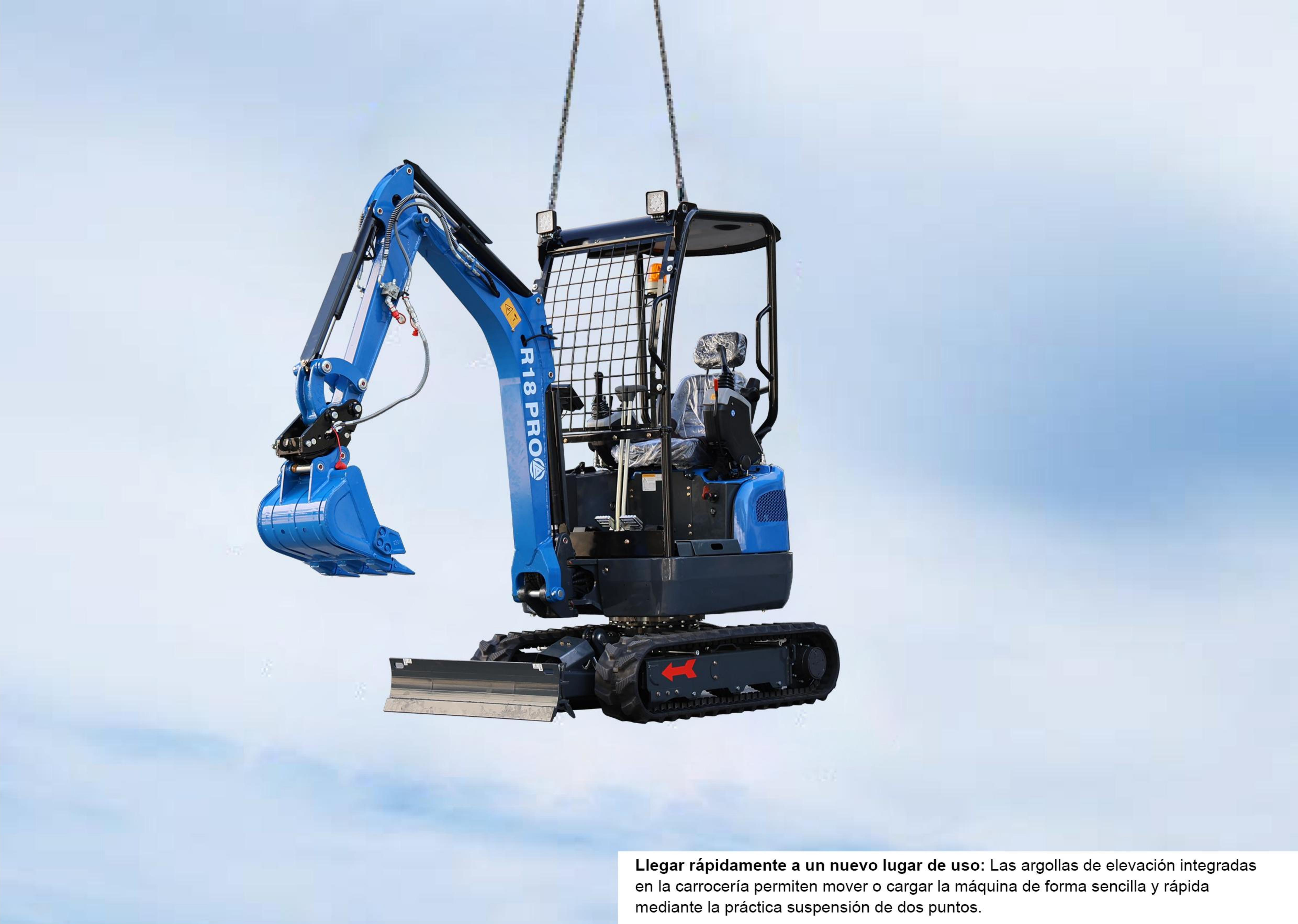
**Llegar rápidamente a un nuevo lugar de uso:** Las argollas de elevación integradas en la carrocería permiten mover o cargar la máquina de forma sencilla y rápida mediante la práctica suspensión de dos puntos.
