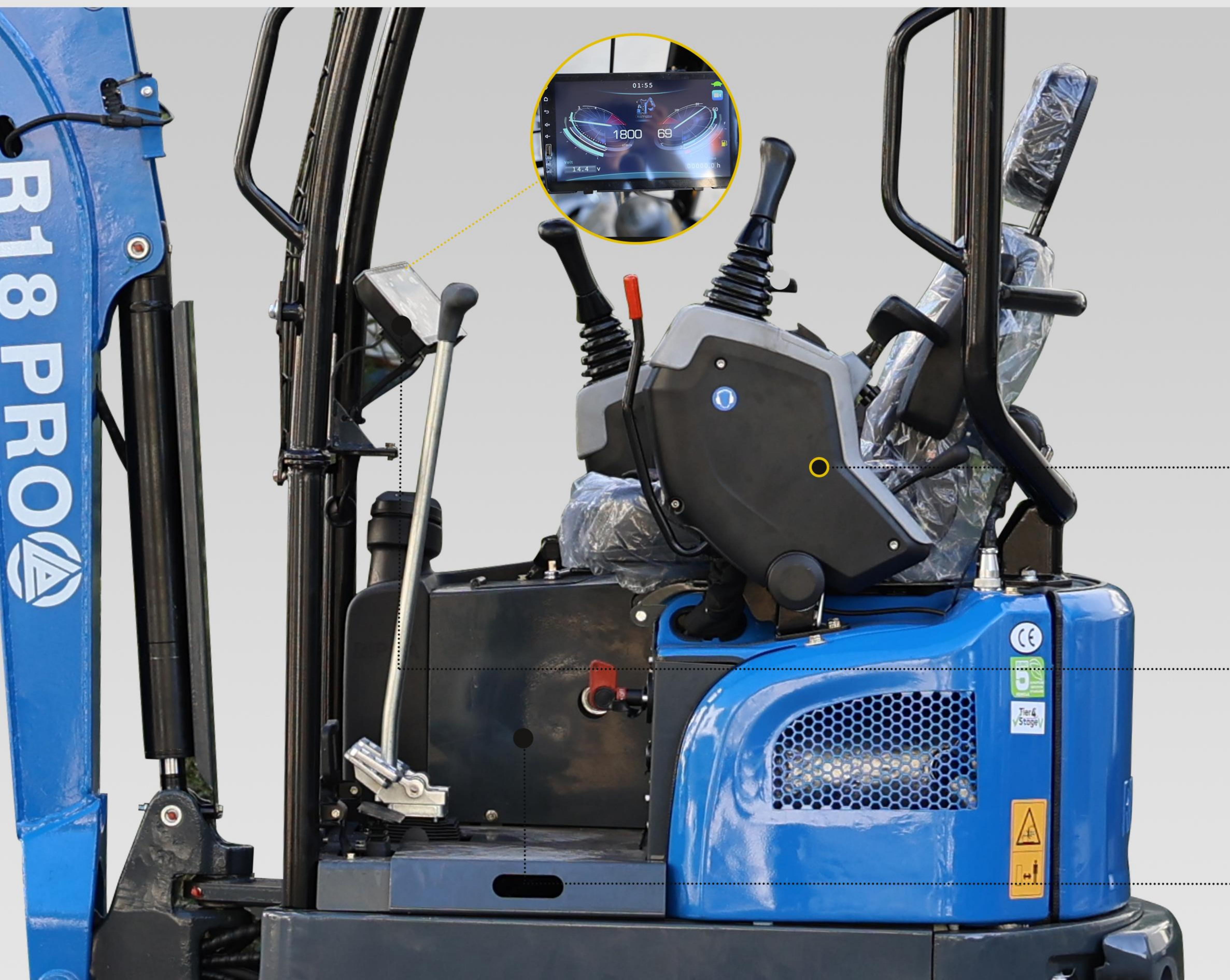
**Todo a la vista y bajocontrol.** Los soportes modulares de las palancas de control permiten un concepto de manejo completamente nuevo con el máximo nivel de claridad y seguridad. Aquí todo está al alcance de la mano y está claramente dispuesto gracias a la perfecta integración del panel de interruptores, el elemento de visualización, el control proporcional, la palanca del acelerador, los reposabrazos ajustables y la palanca de la pala excavadora.
